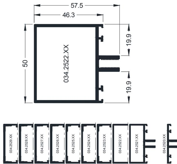
Figure 2 - Profils dormants – ouvrants et profils complémentaires
