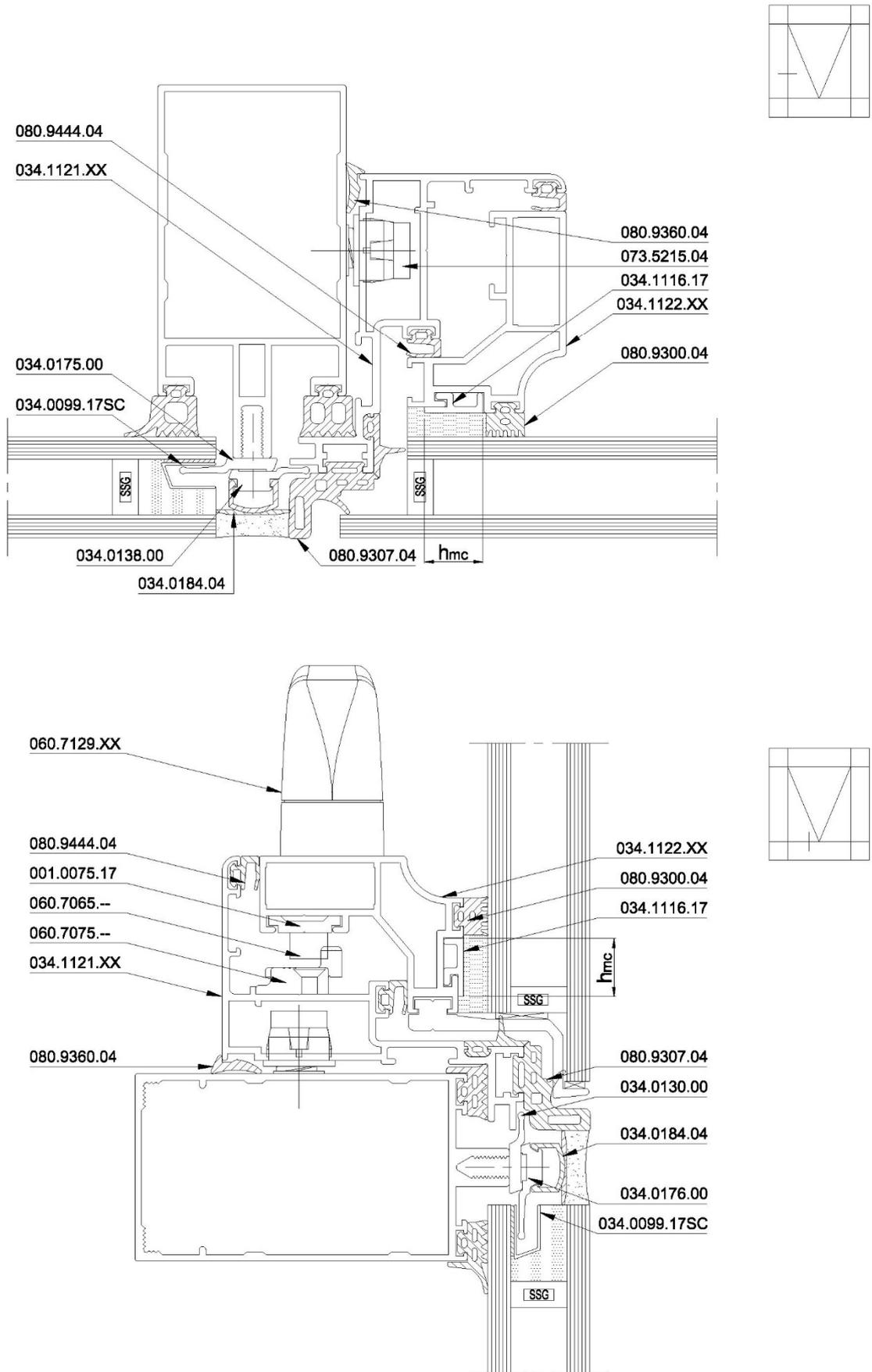
**Figure 31 - Tableau de vitrage pour ouvrant vers l'extérieur - Vitrage à bord décalé**
