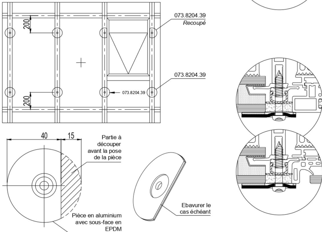
**Figure 9 - Type de fixation et position du profilé U**
