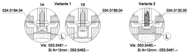
Figure 24 - Partie Fixe - Tableau de vitrage – Capot horizontal / Capot vertical
