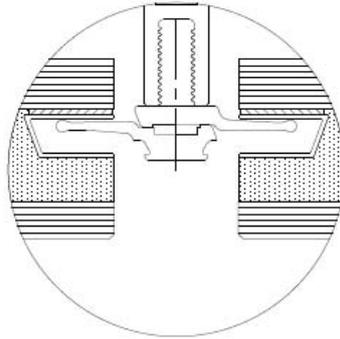
Position possible du profilé U dans le triple vitrage - Choix à faire en fonction des éléments périphériques pour assurer l'alignement du plan de vitrage extérieur.
