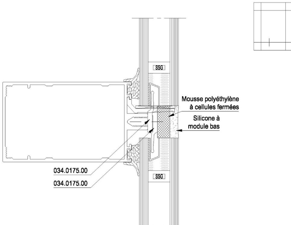
Figure 23 - Partie Fixe - Tableau de vitrage – Avec des clames filantes
