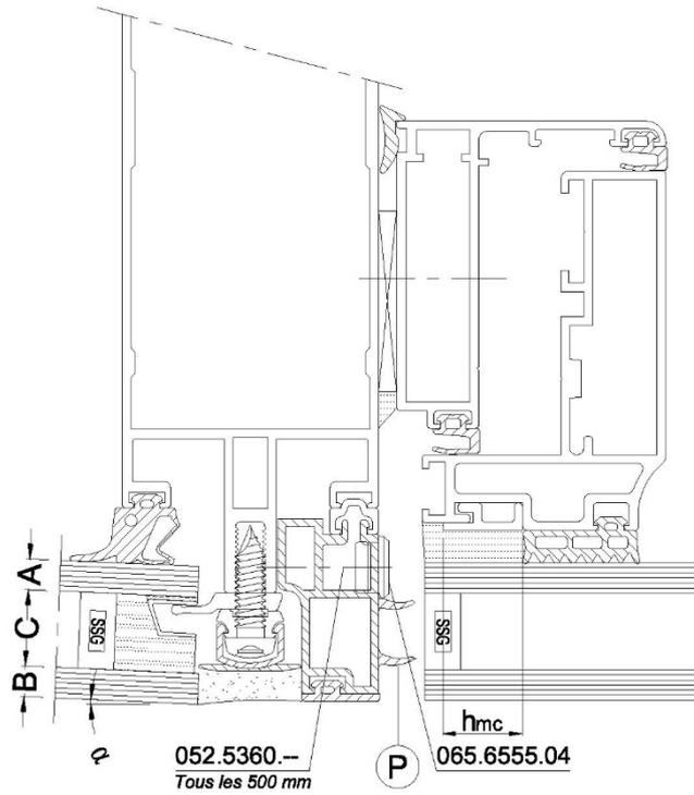
Figure 37 - Tableau de vitrage - Triple vitrage
