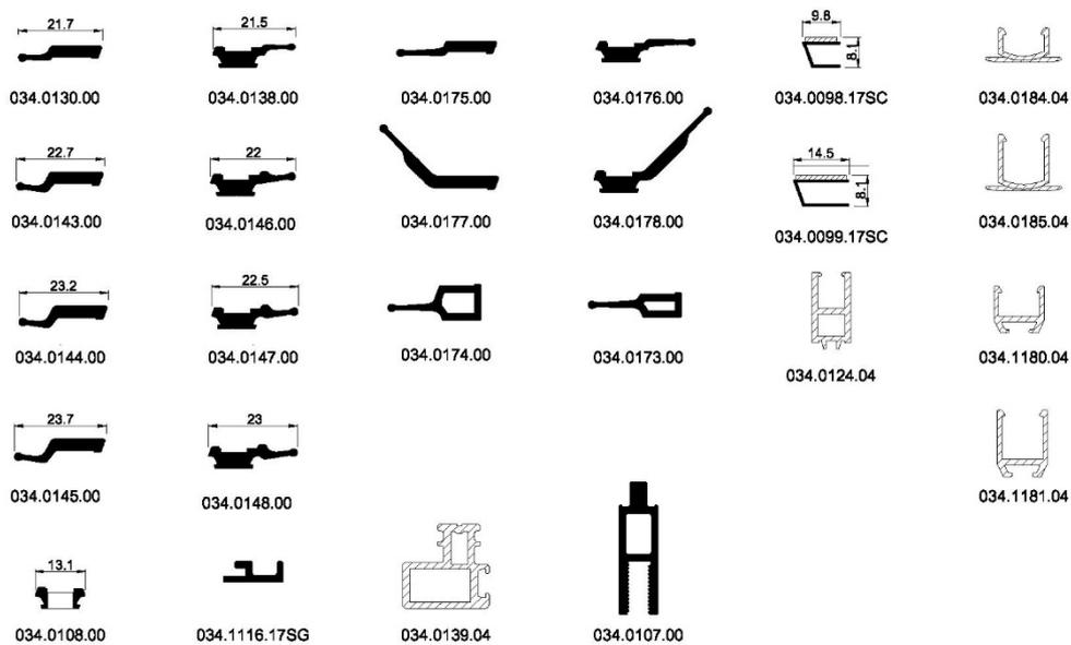
Figure 3 - Support de cale de vitrage
